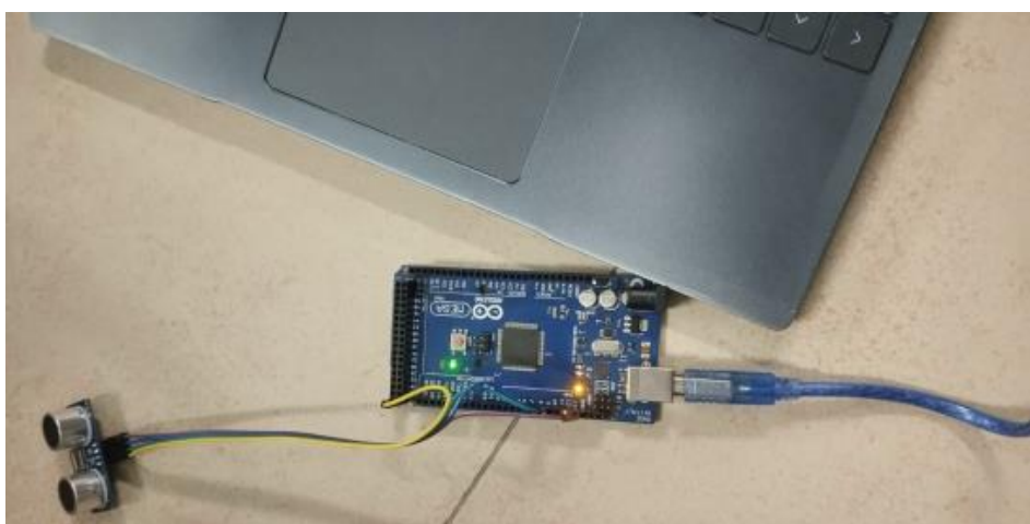
Gambar 2. Rangkaian Sensor Ultrasonik HC-SR04 dan Arduino
