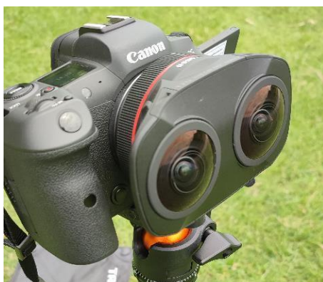
Gambar 3. Canon EOS R5 dan Lensa Stereoscopic
